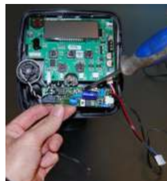
FISSARE LA SCHEDA ELETTRONICA DEL GENERATORE DI CLOLO CON LE DUE VITI IN DOTAZIONE
