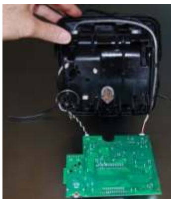
MONTARE IL SUPPORTO SCHEDA ELETTRONICA
